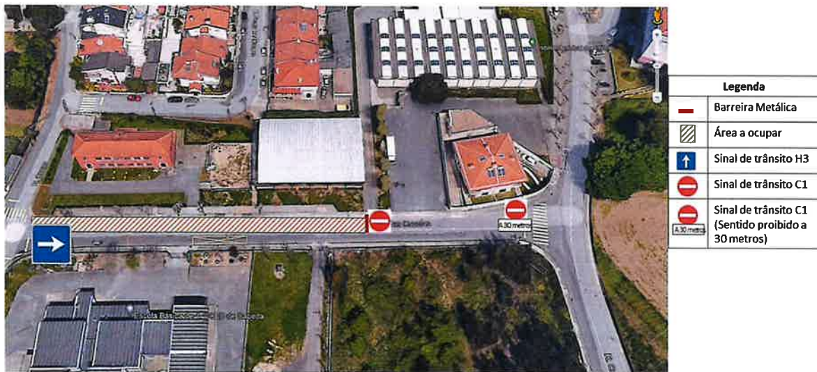
Figura 1 – Ocupação da Rua das Escolas – Sinalização rodoviária temporária.
